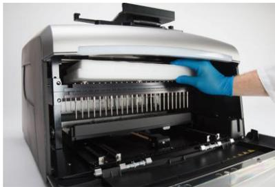
3. タブレット PC ホルダーを持ち上げ、2.5mm 六角レンチで、上部の固定具ネジを外す。
