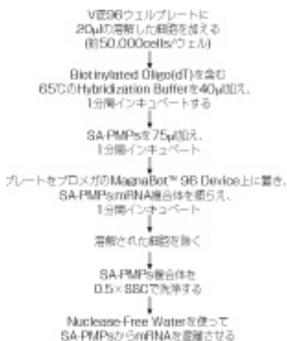
図2. Biomek® 2000 ワークステーションと PolyATtract® mRNA Isolation System を使った自動化 RNA 精製の流れ
