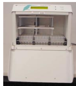
図1. KingFisher™ mL機器を用いたmRNA単離 パネルA: PolyATtract®を使ったmRNA単離用プログラムのステップ。 パネルB: KingFisher™ mL機器。
