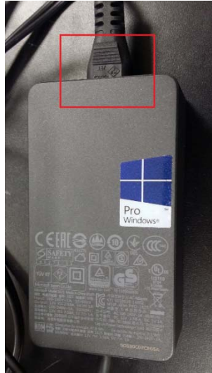
【電源コードの緩み確認】
