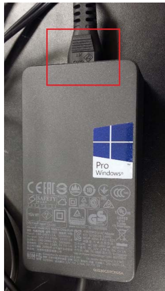
【電源コードの緩み確認】
