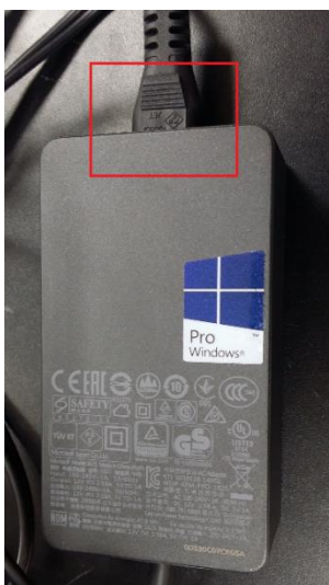
【電源コードの緩み確認】
