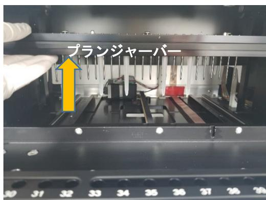
7. 下図のように手でプランジャー全体をつかみ、真後ろに押します。カチッと音がして、ロックが外れて取り外せます。
