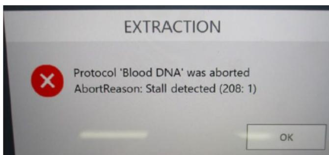
A7. プランジャーが何等かとの衝突などで、通常動作が出来なくなった場合に出てくるメッセージです。まずは、CLEAN UP (Q2.をご参考ください) をして頂き、カートリッジ内部に異物がないか、カートリッジやプランジャーに変形がないか等をご確認ください。Maxwell<sup>®</sup> RSC 48 ソフトウェアでエラーを繰り返す可能性がありますので、一度ソフトウェアを終了し、タブレット PC の電源をオフ、Maxwell<sup>®</sup> RSC 48 Instrument の電源をオフにしてください。そして、再度 Maxwell<sup>®</sup> RSC 48 Instrument の電源を ON、タブレット PC の電源を ON、Maxwell<sup>®</sup> RSC 48 ソフトウェアを起動させてください。その後、5 ページの“6.核酸抽出”を参考に最初からやり直してください。
