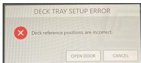
対処法②：チューブの蓋の向きをカートリッジ側にしてセットしますと、Maxwell® RSC 48 Deck Tray の白い点を Vision カメラが検出できない場合があります。特に 48 検体分を設置した場合に特に起こりやすいので、チューブの向きはカートリッジとは逆向き（手前に蓋がある状態）にしてご使用ください。
