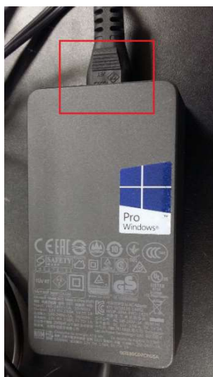
【電源コードの緩み確認】
