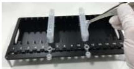
4. インキュベーション後のサンプルを全量(約420μl)をカートリッジのウエル#1に加え、**3-4回のピペティングを行い、十分に攪拌する。**
