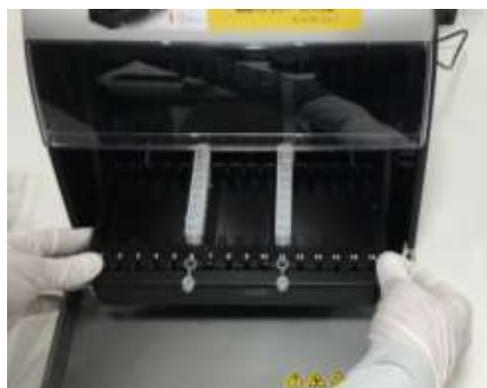
Maxwell RSC 48では、PlungerとElution TubeのセットをCCDカメラでチェックすることができます。
