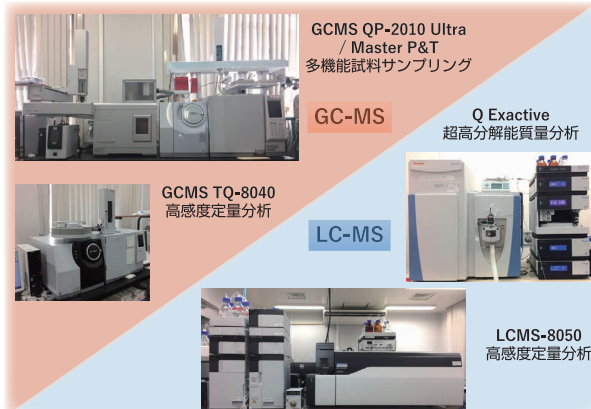
図 1. メタボローム解析の分析装置
