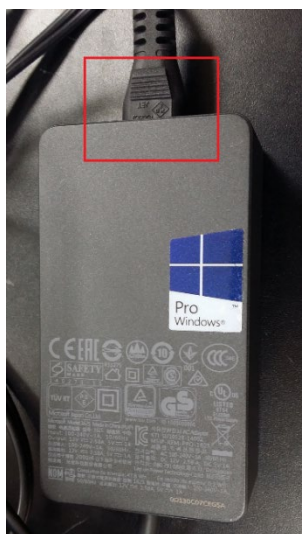
【電源コードの緩み確認】
