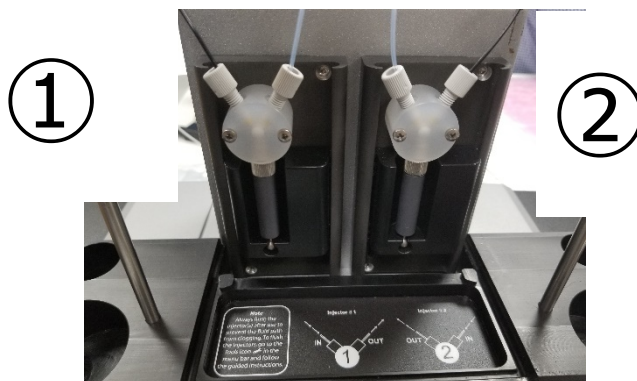
正面からみて左側が Injector1、右側が Injector 2 です。
