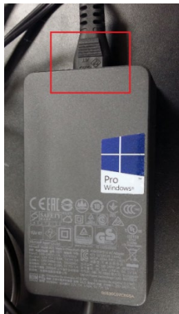
【電源コードの緩み確認】
