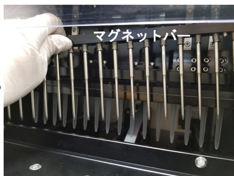
6. 下図のように手でプランジャーバーを手で上に上げます。（プランジャーを取り外すための、手が入る隙間を作るためです）
