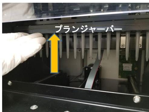
7. 下図のように手でプランジャー全体をつかみ、手前に引きます。カチッと音がして、ロックが外れて取り外せます。
