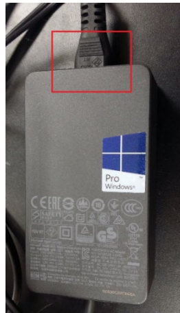
【電源コードの緩み確認】
