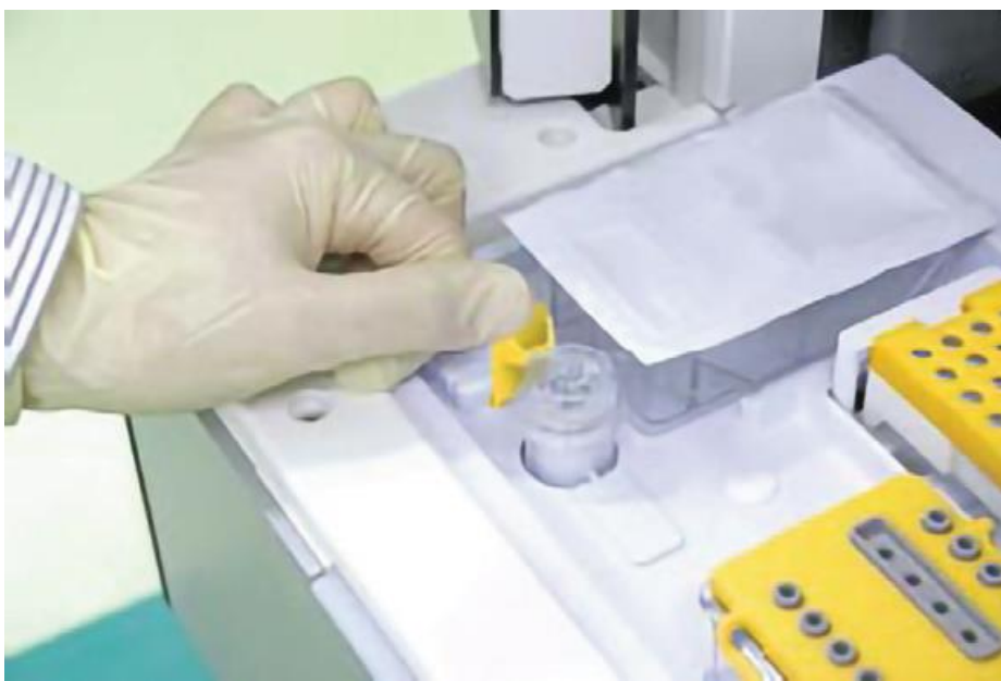
図 29 古いポリマーカートリッジの取り外し
